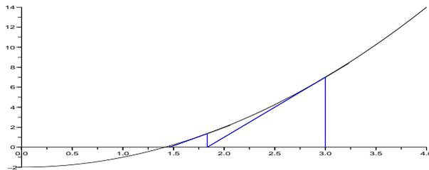
FIG. 2 – Schéma de la méthode de Newton pour le calcul d'une approximation du zéro de  $f(x) = x^2 - 2$  (qui n'est autre que  $\sqrt{2}$ ), avec  $x_0 = 3$  comme première approximation. On trouve successivement  $x_1 \simeq 1,833$  puis  $x_2 \simeq 1,462$ .
