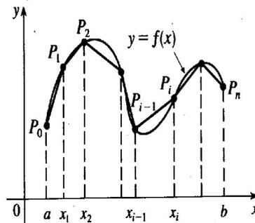
FIG. 1 – Approximation de la longueur d'un arc de courbe par celle d'une ligne polygonale.
