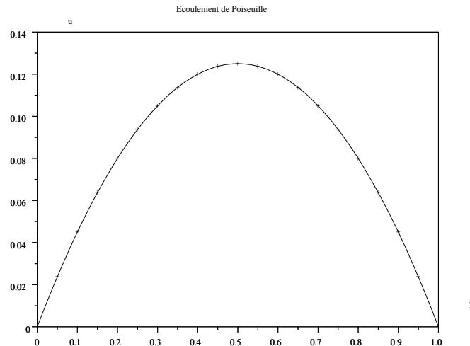
FIG. 4 – Comparaison entre la solution calculée (+) et la solution analytique  $u_e = y(y - 1)/2$  pour une valeur de  $x$  fixée.
