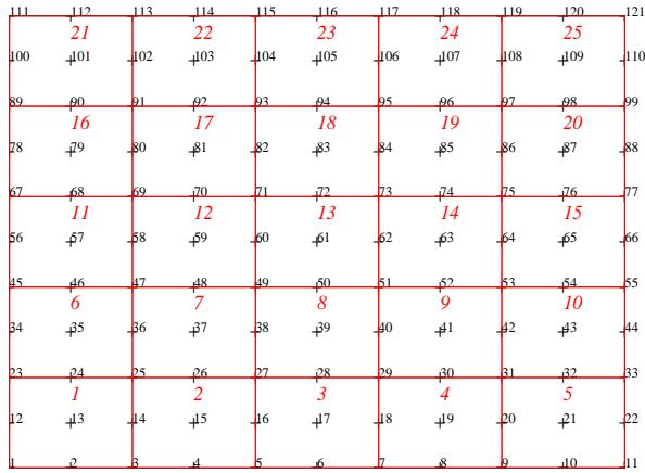
FIG. 1 – Exemple de maillage avec  $\text{Nelt} = 25$  et  $\text{Npt} = 121$ .
